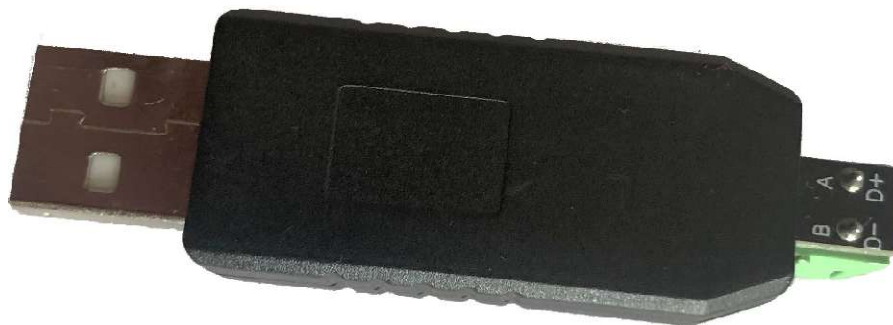
Fot. 3.2.5 Konwerter USB->RS485 widok od strony opisu
