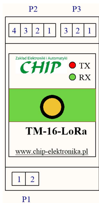
Rys. 3.1 Widok modułu TM-16 z oznaczonymi złączami
