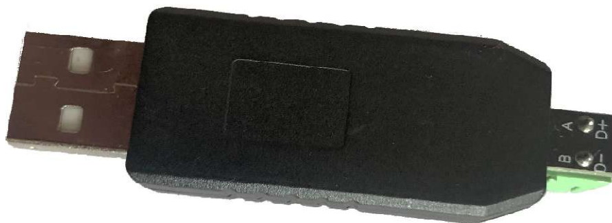
Fot. 3.2.5 Konwerter USB->RS485 widok od strony opisu
