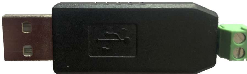
Fot. 3.2.4 Konwerter USB->RS485 widok od strony zacisków
