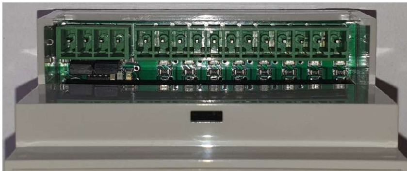
Fot.3.2.1 Widok zamontowanych zworek terminatora
