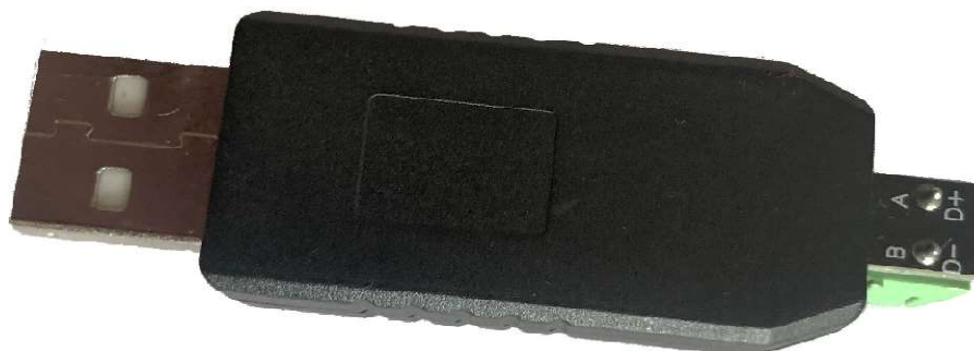
Fot. 3.2.5 Konwerter USB->RS485 widok od strony opisu
