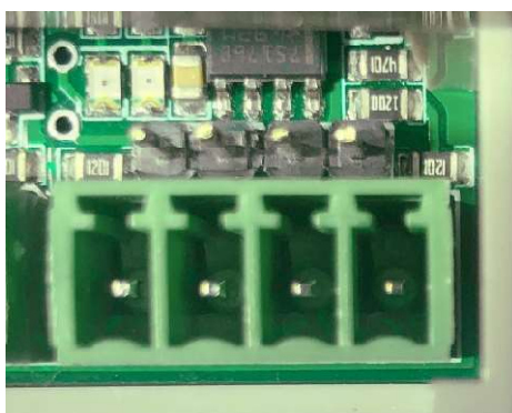
Fot. 3.2.1 Widok złącza P5 wraz z kołkami zworek terminatora
