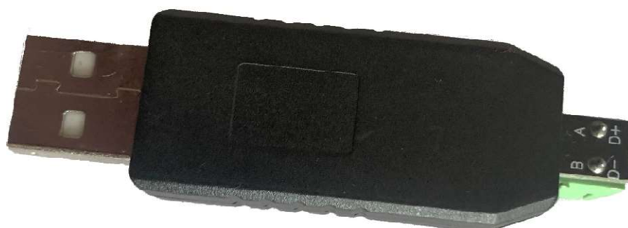
Fot. 3.2.5 Konwerter USB->RS485 widok od strony opisu
