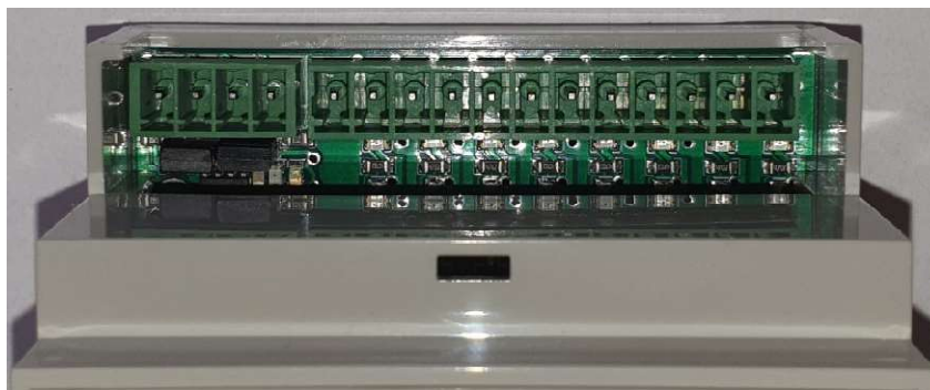
Fot.3.2.1 Widok zamontowanych zworek terminatora
