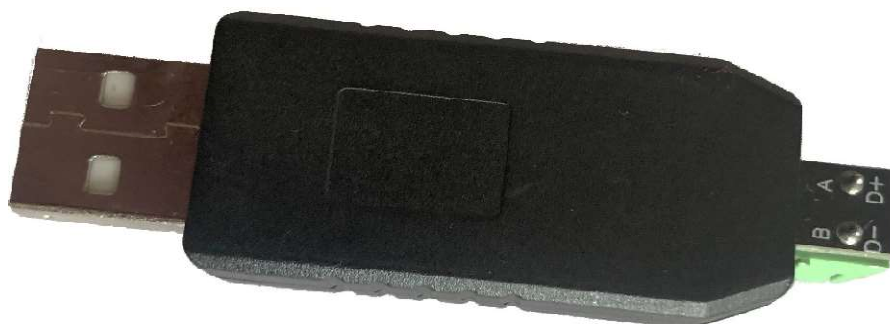
Fot. 3.2.5 Konwerter USB->RS485 widok od strony opisu
