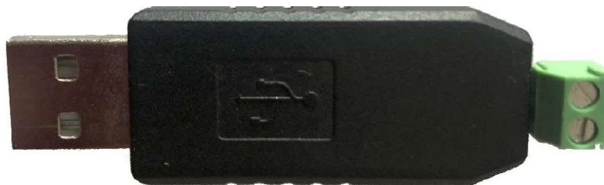
Fot. 3.2.4 Konwerter USB->RS485 widok od strony zacisków
