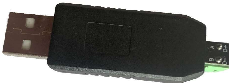
Fot. 3.2.5 Konwerter USB->RS485 widok od strony opisu
