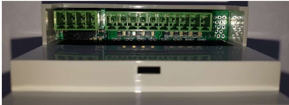
Fot.3.2.1 Widok zamontowanych zworek terminatora
