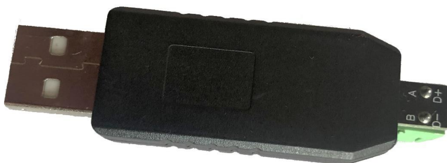
Fot. 3.2.2 Konwerter USB->RS485 widok od strony opisu
