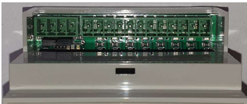
Fot.3.2.1 Widok zamontowanych zworek terminatora
