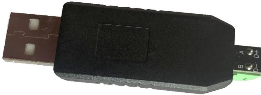
Fot. 3.2.5 Konwerter USB->RS485 widok od strony opisu
